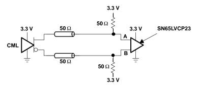
Figure 17. Current-Mode Logic (CML)
