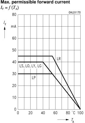
Maximal zulässiger Durchlaßstrom Max. permissible forward current
