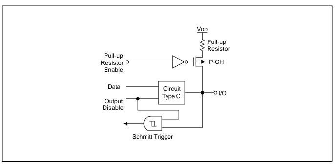
Figure 1-8. Pin Circuit Type E-3
