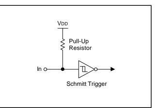
Figure 1-5. Pin Circuit Type B
