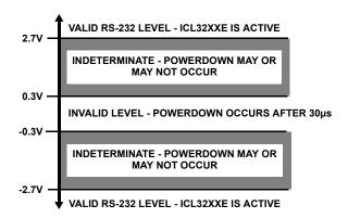
FIGURE 6. DEFINITION OF VALID RS-232 RECEIVER LEVELS
