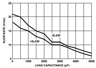
FIGURE 14. SLEW RATE vs LOAD CAPACITANCE
