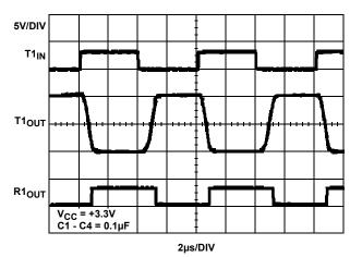
FIGURE 12. LOOPBACK TEST AT 250kbps
