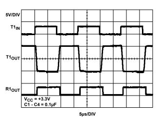
FIGURE 11. LOOPBACK TEST AT 120kbps
