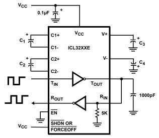
FIGURE 10. TRANSMITTER LOOPBACK TEST CIRCUIT
