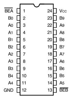
SOIC/ QSOP/ TSSOP TOP VIEW
